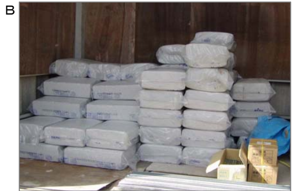
B 吹きつけ綿の在庫(写真は岩綿材)。最近30年間は、同じような梱包形態です。袋が運搬途中に破れて、商品の運搬に携わった運転手がばく露する可能性があります。
