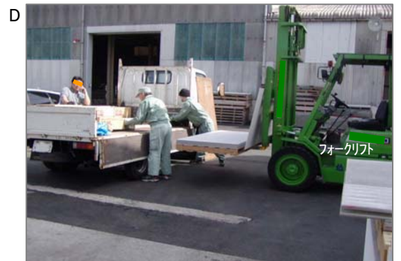
D 石綿含有ボードの出荷状況。多量時はフォークリフトを使用しますが少量の時は手積みします。スレート板に比べてけい酸カルシウム板の方がやや粉っぽいです。
